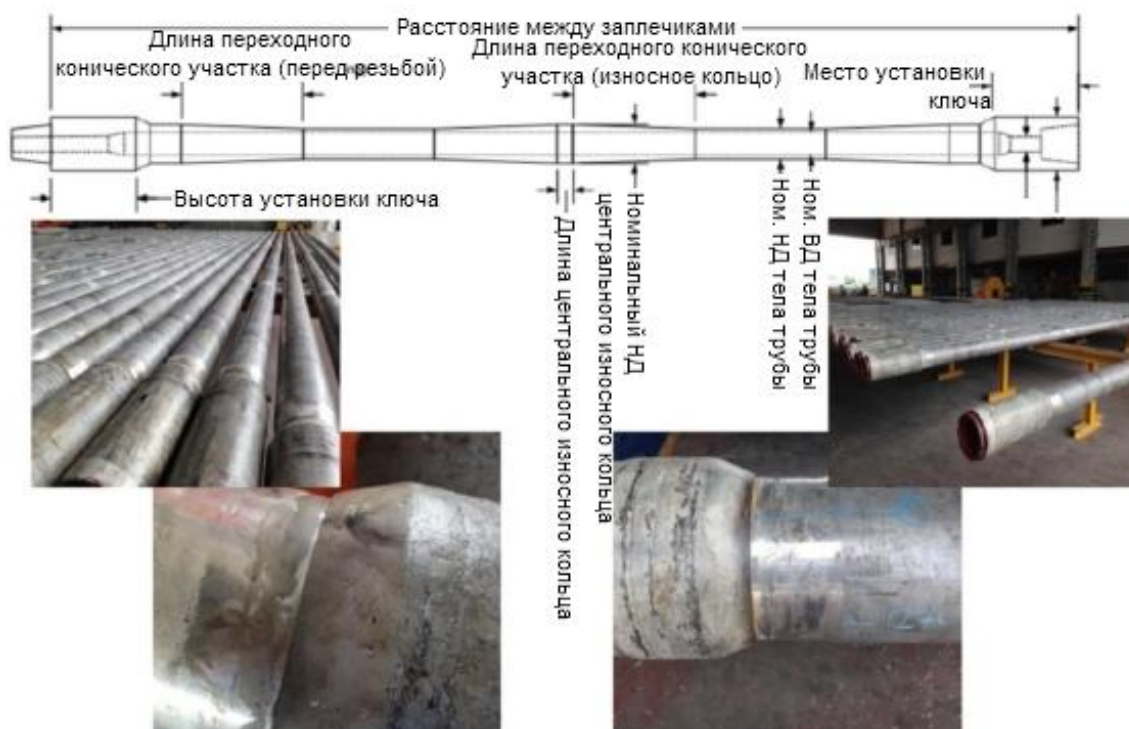
Рисунок 2 — геометрия и особенности алюминиевых бурильных труб
