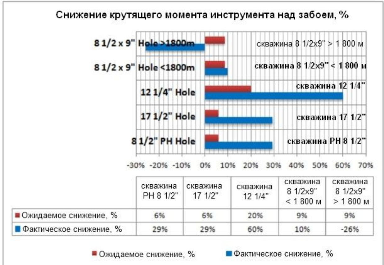
Рисунок 11 — ожидаемое и фактическое снижение крутящего момента инструмента над забоем
