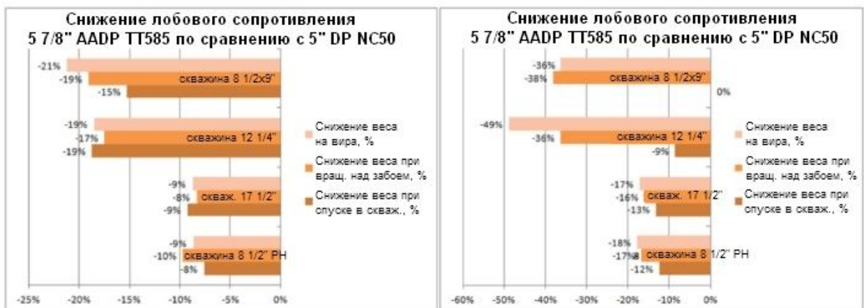
Рисунок 10 — ожидаемое и фактическое снижение лобового сопротивления
